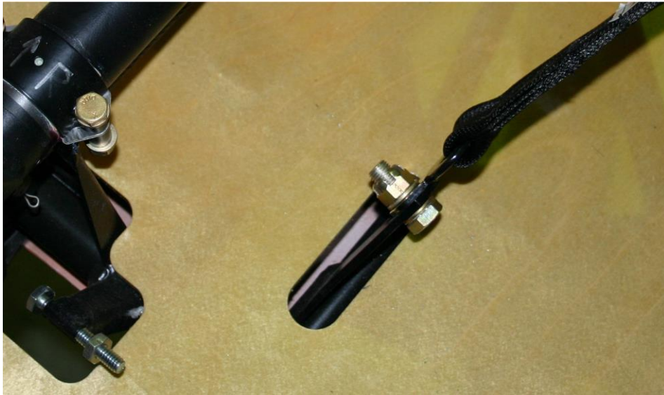
图 1 - 飞行员右侧安全带附件，锁紧螺母(螺栓头面对飞机中心线)
