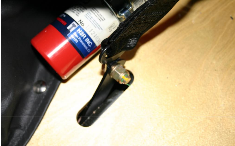
图 1 - 飞行员右侧安全带附件，锁紧螺母(螺栓头面对飞机中心线)
